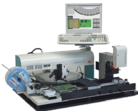
Полуавтомат установки компонентов EXPERT-SA
