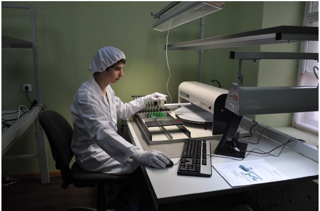
Печь оплавления припоя RO-06plus
