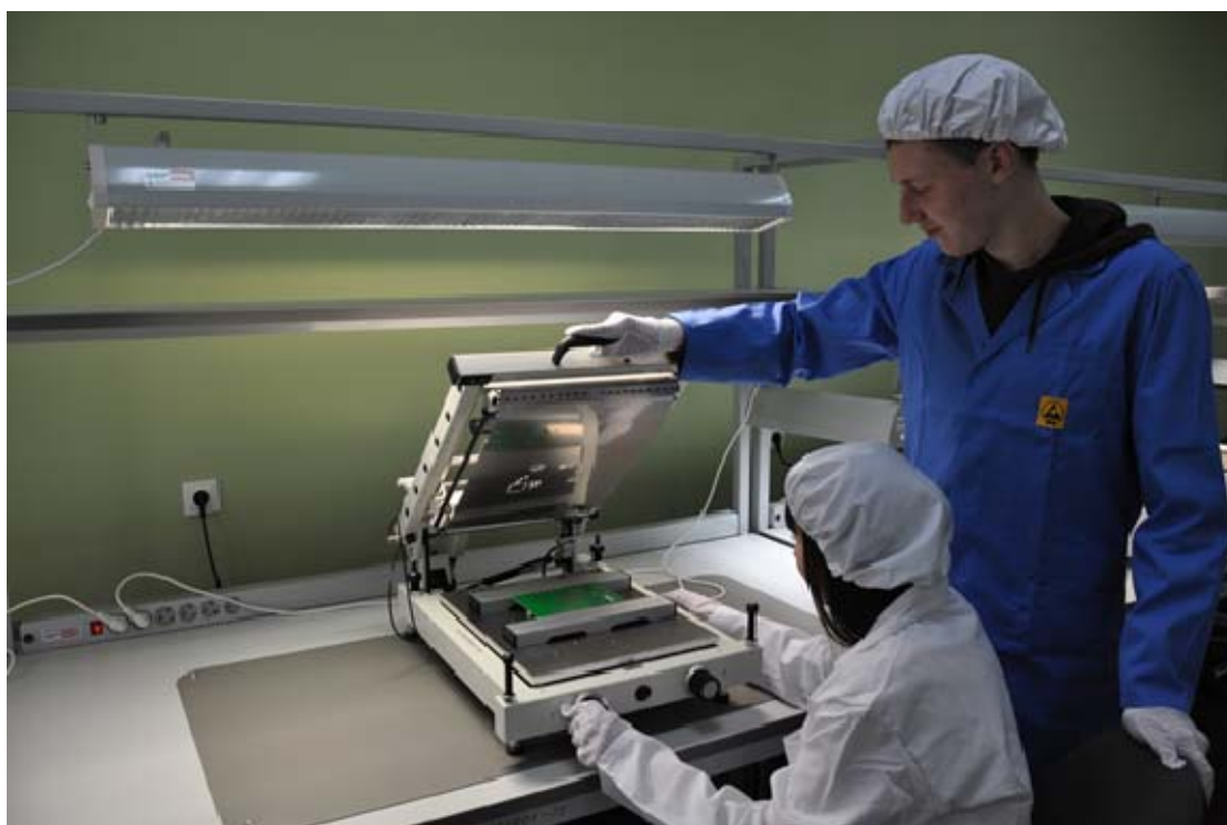
Полуавтомат установки компонентов EXPERT-SA
